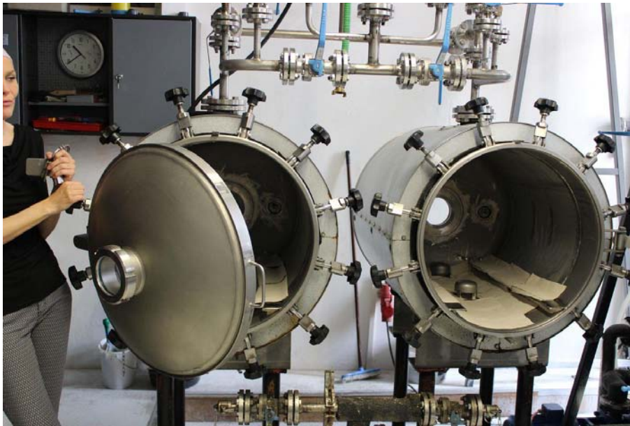
Abb. 27: Behandlungskammern des PAL Book Safer® zur Massenentsäuerung
