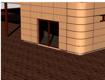
Abbildung 1 Eckausbildung einer Sperrholzfassade
