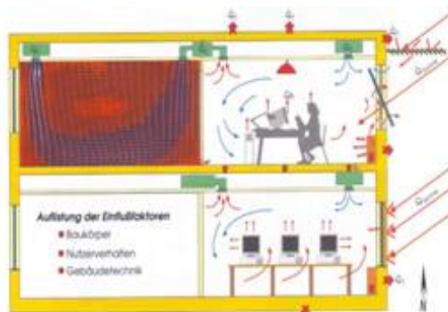
Fünf-Tage-Simulation mit Außenklimadaten nach VDI 2078 (sommerl. Extremfall)
