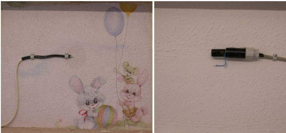
Abb. 21 + 22: Die Testflächen „Tapete“ und „Farbe“ in Raum B (Lüftungsanlage) weisen bisher keine Verkeimung auf.
