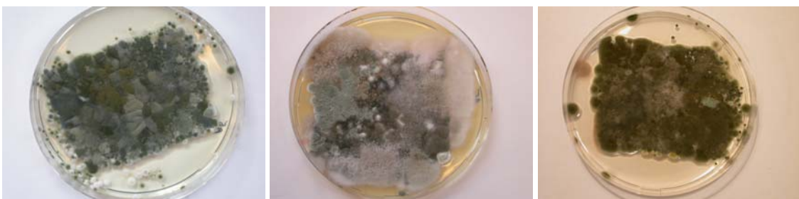
Abb. 12 bis 14: Die Kontaktproben der Testfläche „Tapete“ in Raum A vom 13.10.04, 11.11.04 und 30.11.04 auf Malz-Nährboden. Die Proben zeigen einen dichten Bewuchs mit Schimmelpilzen, vornehmlich Cladosporium -Arten.
