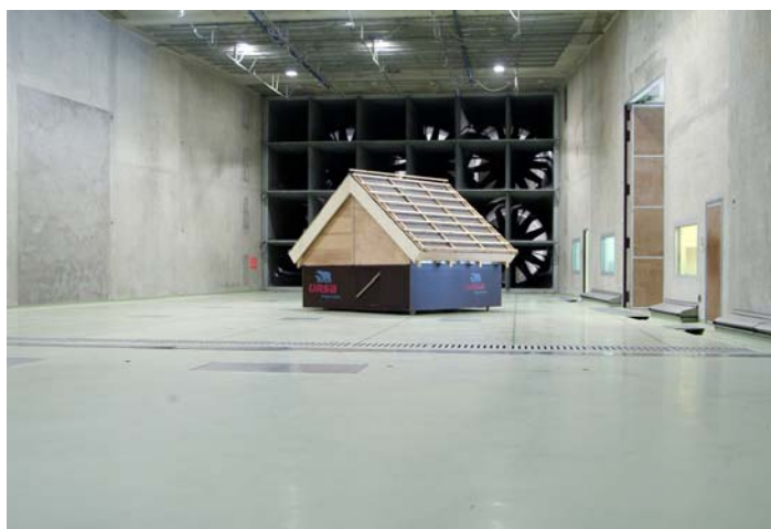
Bild 1: Testhauses im Windtunnel
