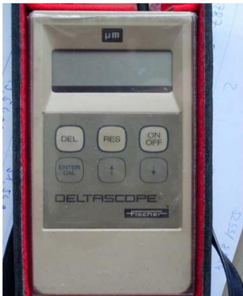
Abbildung 27 Induktionsmessgerät
