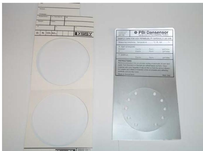
**Abbildung 17 Messkarten zur Probenaufnahme**
