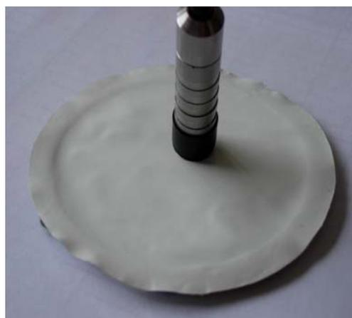
Abbildung 28 Induktionsmessung
