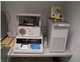
Die Diffusionsmessungen können normkonform gravimetrisch und/oder mit mikroprozessor gesteuerter Sensortechnik durchgeführt werden (Lyssy-Methode). Zu den genormten Verfahren gehören z. B. EN ISO 12572, EN 1931, EN ISO 12571 und die darin enthaltenen Klimate.
