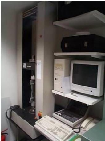
Wir sind in der Lage, durch Zug-, Druck- und Biegezugprüfungen die mechanischen Eigenschaften von verschiedenen Baustoffen zu bestimmen. Neben normgerechten Prüfungen können darüber hinaus herstellerspezifische Prüfmethoden mit einer benutzerdefinierten Versuchssteuerung durchgeführt werden:
