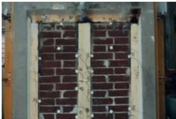
In Brandkammern von Kooperationspartnern führen wir Brandschutzprüfungen als Voruntersuchungen zur Zulassung oder zur Zulassung im Einzelfall mit und ohne Auflast auf das Bauteil durch.
