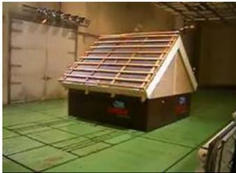
Die technische Ausrüstung der Prüfräume ermöglicht es, nicht nur das thermisch-hygrische Verhalten der Bauteile bei extremen Temperaturen (-25 - +50 °C) zu beobachten, sondern alle klimatischen Belastungen realistisch nachzustellen.
